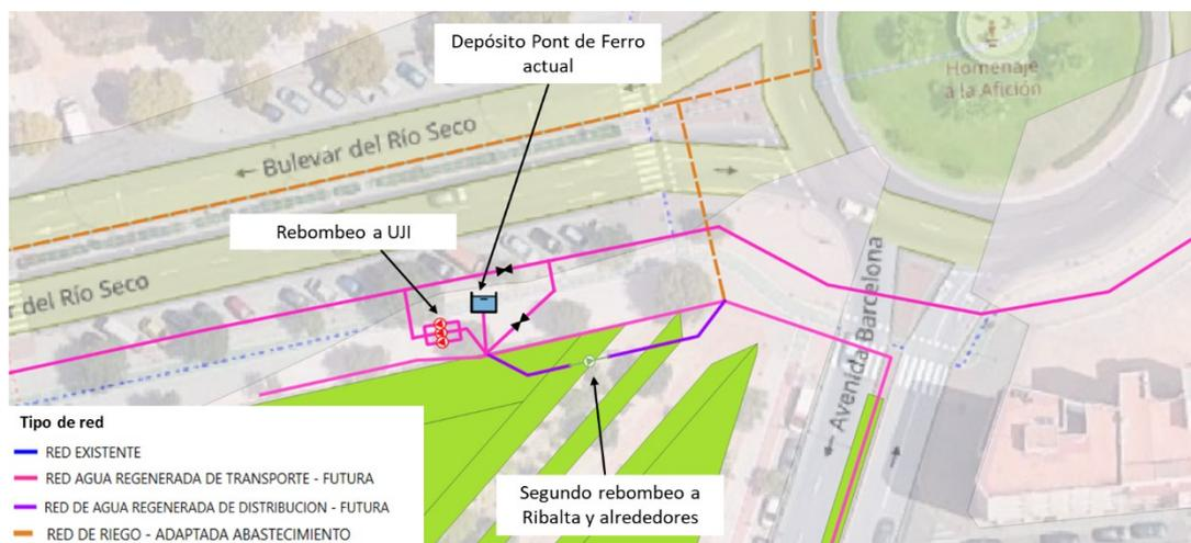
Figura 60. Detalle del trazado de tuberías, depósitos y válvulas en las inmediaciones de la EB de Pont de Ferro.
