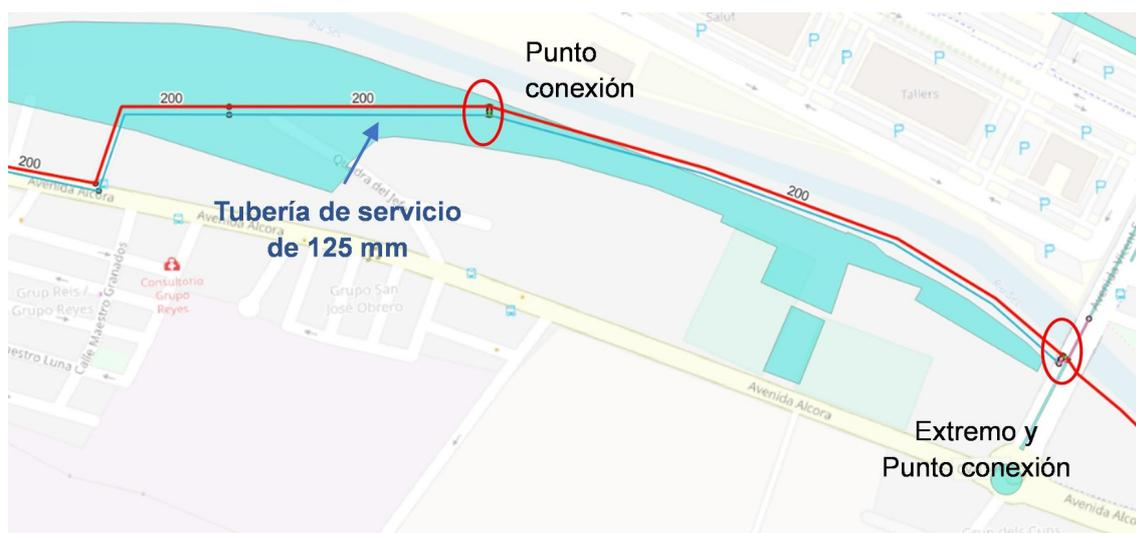
Figura 58. Tubería de servicio (en azul) paralela a la tubería de impulsión y puntos de conexión estratégicos
