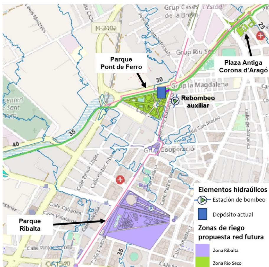
Figura 40. Jardines en torno al depósito de Pont de Ferro, cuyo riego exigirá un nuevo rebombee auxiliar, independiente del rebombee de elevación al nuevo depósito, y trazado de las tuberías alimentadas desde el mismo.
